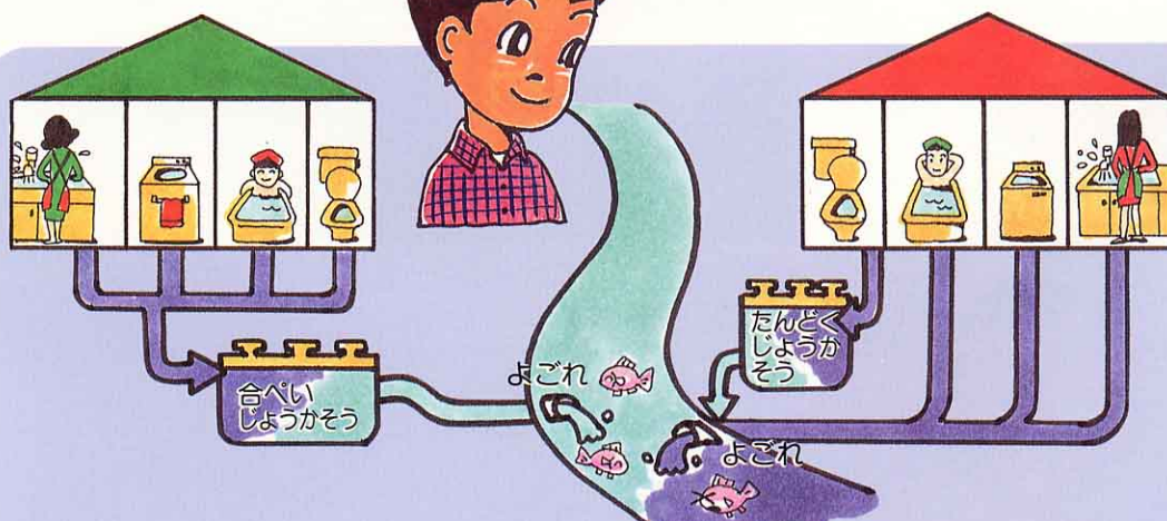
「合併浄化槽」と「たんどく浄化槽」
