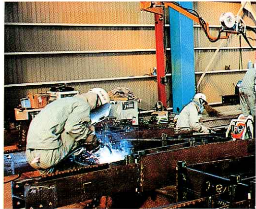
ビルなどの鉄骨 てっこつ をつくらしている工場
