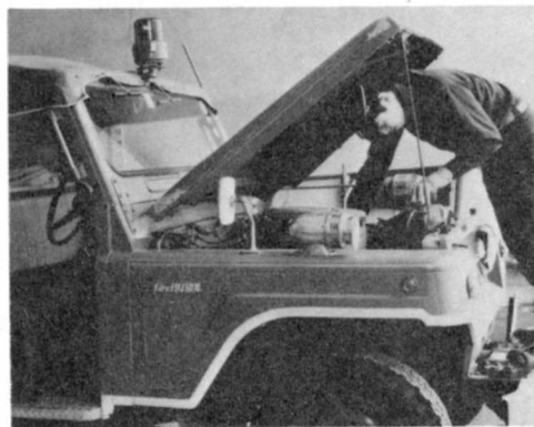
ポンプ自動車の点検
