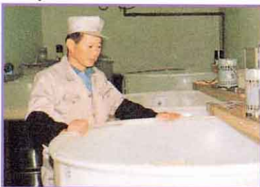
④こうじに、むし米と水をまぜてはっこうさせ、酒母(もと)をつくる。
