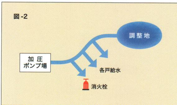
◀ 加圧ポンプ場で、地下水を押し上げる。各家庭に給水しながら配水池に水を貯める。水が貯まると、加圧ポンプが止まり、調整池から給水される。
