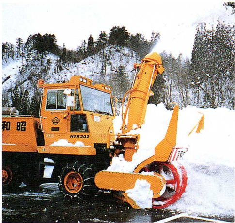
▲ロータリーによる除雪
