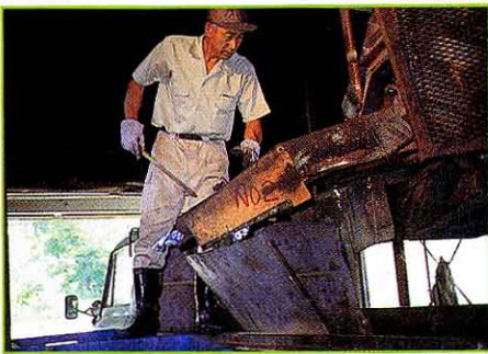
②機械に入れてアルミ・鉄などに分けられます。
