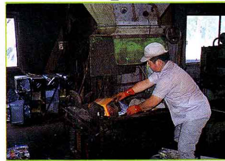
③アルミ・鉄は、機械でプレスされます。(つぶされます。)
