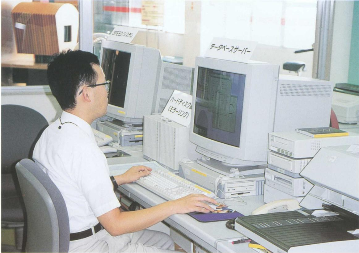
福島県では、環境放射能の常時監視体制を一層強化するため、昭和50年6月に、他県に先がけて環境放射能監視テレメーターシステムを採用しました。このシステムは、原子力発電所周辺の環境放射線等を常時監視するため、モニタリングポスト、ダストモニタ、気象観測装置からの測定結果をコンピュータで処理し、測定値を表示盤に表
