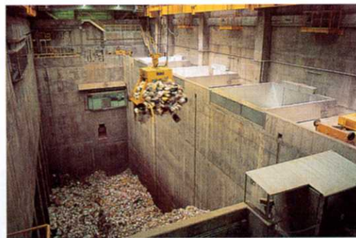
ごみピット ごみをためておくところ、ここからクレーンでしょうきゃくろにごみを送られます。
