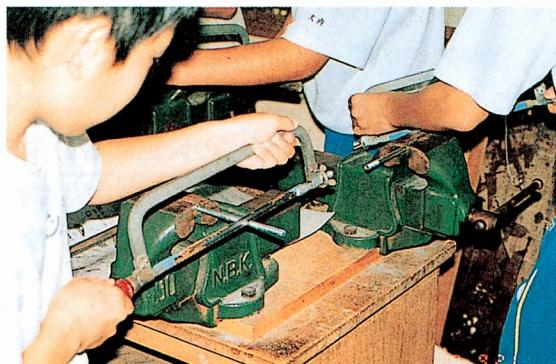
弓のこによる金属棒切断では、材料に大きな力がかかるので、万力でしっかりと固定する必要がある。また、両刃のこぎりと同じように引く時に力を入れる生徒がいるので、刃の向きに着目し押す時に力を入れるよう助言した。
