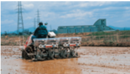
高性能播種機 ほしゆ による直播栽培 ちよくは (郡山市) (注)直播栽培=稲のたねを直接水田にまき、田植えをしないで米をつくる方法
