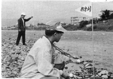
図-52 流速の測定と目印(福島市須川)
