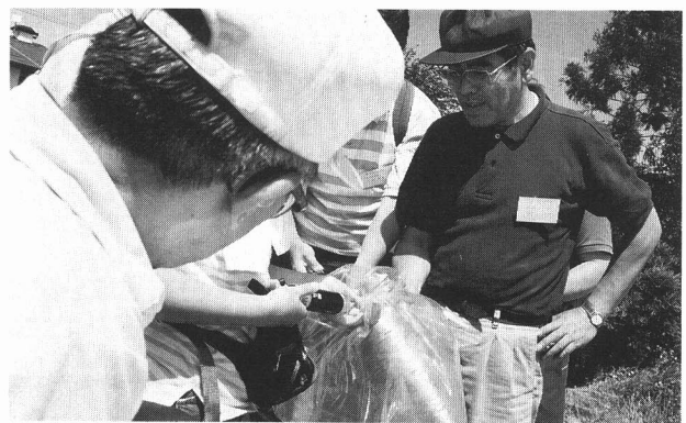
＜気体検知管を用いた大気汚染調査＞
