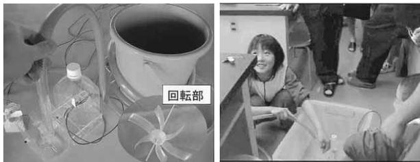
水力発電装置(発電部に光電池用モーターを用いた。回転部にはペットボトルを切り取った小片を使用)
