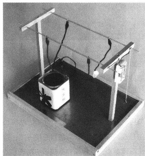
この装置は、配電線と漏電している洗濯機のモデルである。
