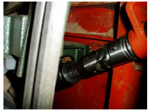
→ 清掃後の丸のこ刃の昇降部
