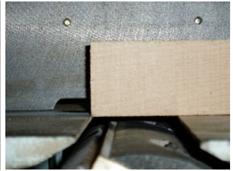
→ 刃を境として、材料を支えるための台の高さが同じであったことが原因と判明 → 右側の台を低く調整
