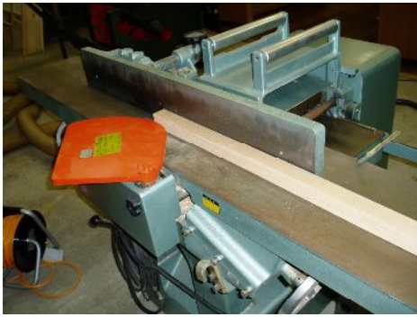
手押しかな盤で削ると、角材の最後の部分が多く削れる症状が出た
