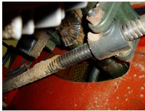
→ 清掃中の丸のこ刃の昇降部
